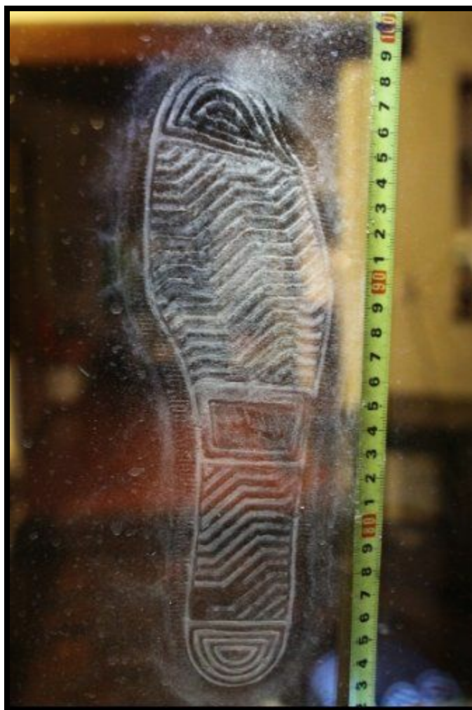
Fotografía 9. Toma en detalle de rastro de pisada sobre vidrio con referencia escalada.
