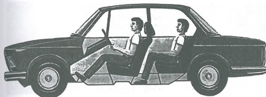
FIGURA III.9. Traumatismos en los ocupantes de un vehículo. El conductor se golpea la cara en el parabrisas, el tórax en el volante y las rodillas en el panel de instrumentos, el acompañante del asiento posterior se golpea la cara y las rodillas en el respaldo del asiento delantero.
