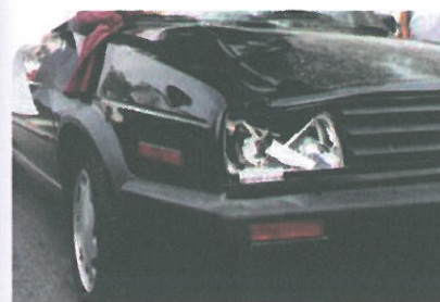
FIGURA VI.6. Daños causados por cuerpo blando en su parte frontal derecha.
