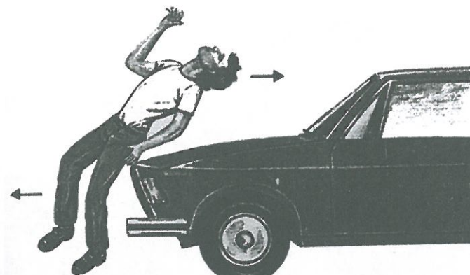
FIGURA III.12. Fase de choque o impacto primario. En un primer tiempo el peatón es golpeado por las partes anteriores del vehículo por debajo del centro de gravedad.
